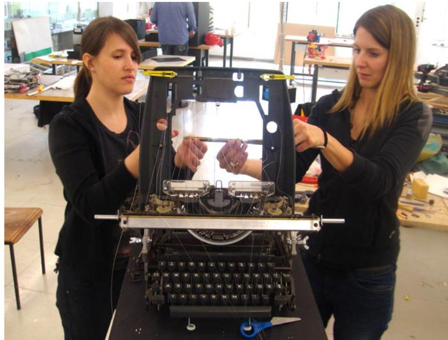
wir haben eine alte mechanische schreibmaschine zerlegt und einzelne bestandteile davon wieder benutzt, um damit eine räumlich lesbare schrift zu konstruieren. mit dem drücken der schreibmaschinen-tasten werden über vertikal gespannte stahldrähte messingrohrstäbe gehoben oder gesenkt. ausgehend von der vierteiligen stenographiezeile bewirkt dies ein dreidimensionales, leicht nachvoll-ziehbares schriftbild.
